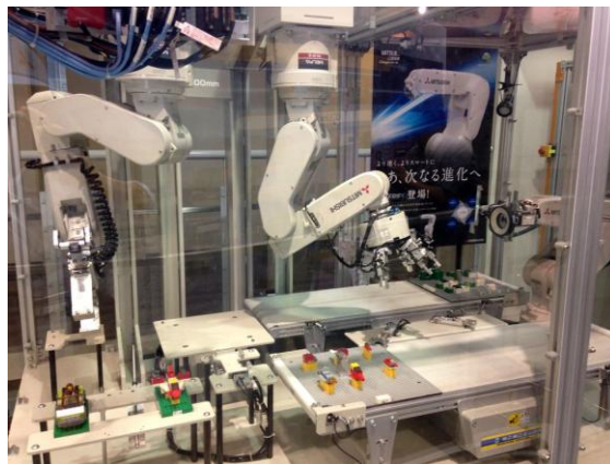
展示的四台机器人协同完成高难度的部件组装
